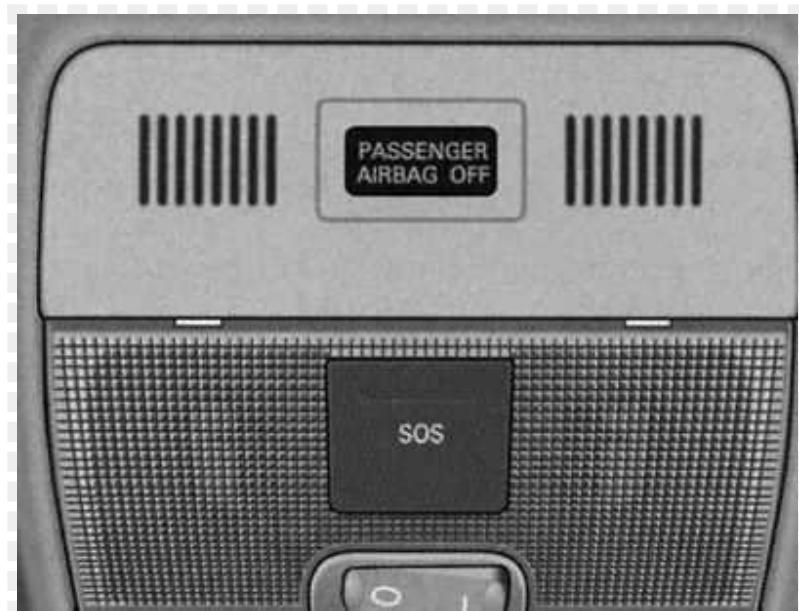
Под крышкой находится устройство подачи сигнала бедствия SOS и вызова технической помощи.
