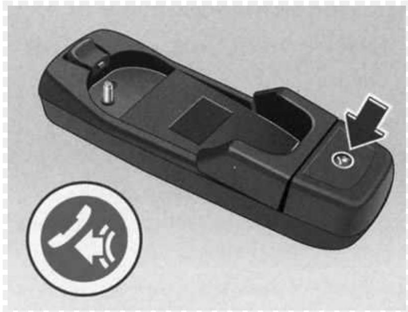
Клавиша голосового управления автомобиля без многофункционального рулевого колеса
